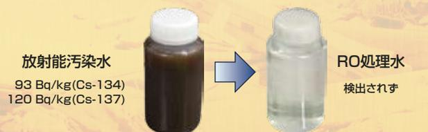
放射性セシウムが含まれる放射能汚染水を、弊社RO(逆浸透膜)純水装置にて処理。
